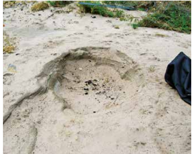
Foto 2: Strudellöcher mit Materialauswurf im Bereich des Rutschungskessels (Aufnahmedatum 28.08.2009)
