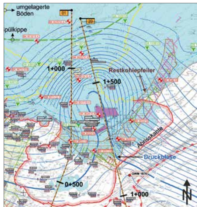
Abb. 11: Druckblase unter dem Rutschungskessel infolge der im Rahmen der Ursachenforschung identifizierten hydrogeologischen Anomalie einer Rinnenstruktur im Grundwasserleiter GWL 6.3
