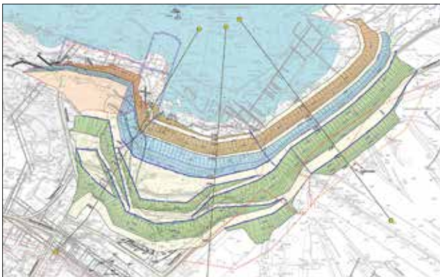
Abb. 6: Lageplan Endböschungssystem Hauptutschungskessel und östliche Rutschungsflanke
