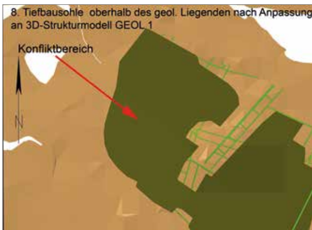
Abb. 7: Bruchfeld der 8. Tiefbausohle im Bereich des untertägigen Nachbaues (Konfliktbereich 10) nach Anpassung an „3D-Strukturmodell (GEOL 1)“ - Stand 2016
