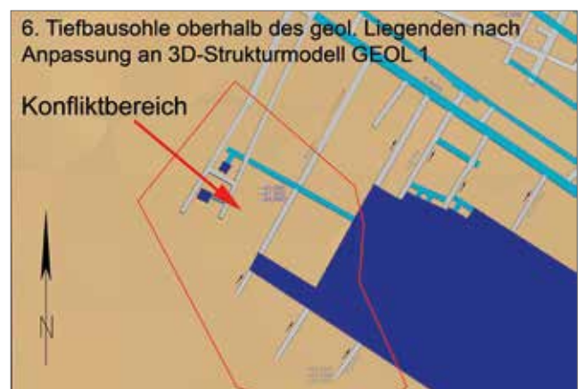
Abb. 9: gleicher Bereich wie Abb. 8, Verschnitt mit dem geologischen Liegenden „3D-Tiefbaumodell (TIEF)“ – (Stand 04/2013) nach Anpassung an das „3D-Strukturmodell (GEOL 1)“
