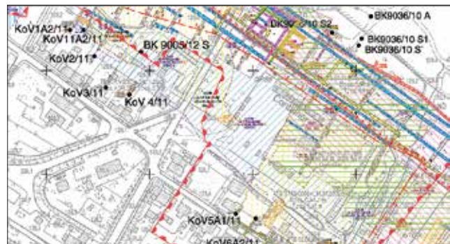
Abb. 5: Rissausschnitt Haldenstraße in Nachterstedt mit Darstellung der Kontrollversatzbohrungen 2010-2012
