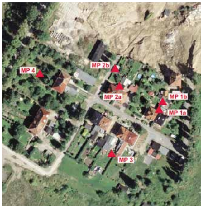
Abb. 1: Übersicht Messpunktstandorte (MP 1a, 2a, 3, 4 seismische Sensoren, MP 1a+b, MP 2a+b Neigungsgeber)
