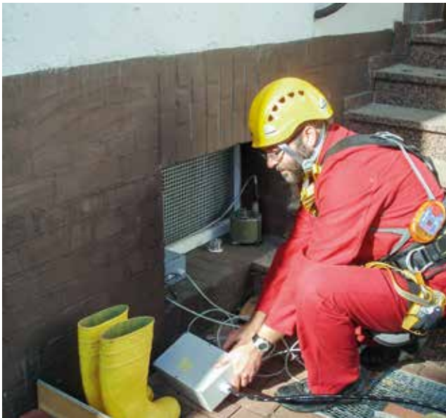
Foto 5: Aufbau seismischer Messpunkt in einem Wohnhaus der Siedlung „Am Ring“
