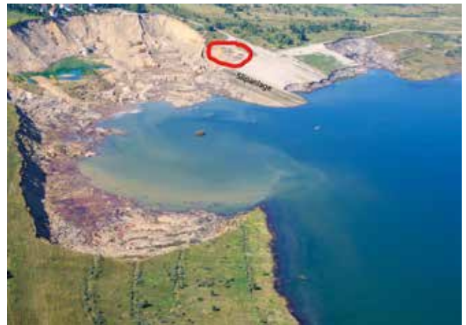
Foto 21: Rutschungskessel mit Kennzeichnung der Teilfreilegung Altablagerung und Slipanlage
