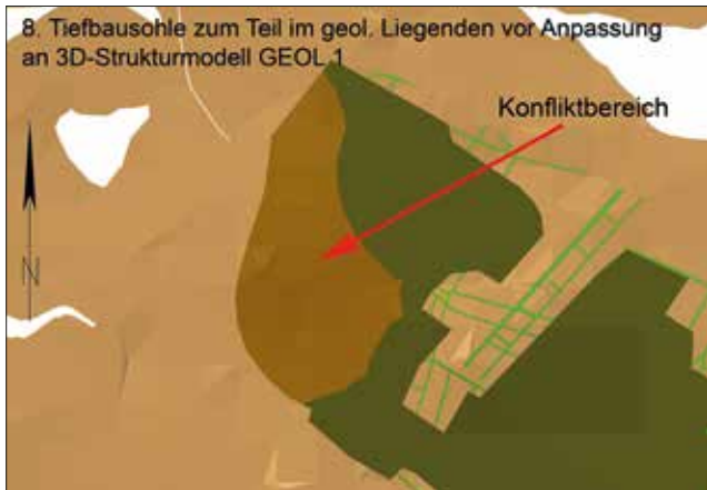
Abb. 6: Bruchfeld der 8. Tiefbausohle im Bereich des untertägigen Nachbaues (Konfliktbereich 10) vor Anpassung an „3D-Strukturmodell (GEOL 1)“ - Stand 2013
