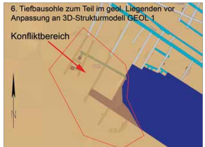
Abb. 8: 6. Tiefbausohle im Bereich zwischen Haldenstraße und ehemaligem Tagebau im Verschnitt mit dem geologischen Liegenden, „3D-Tiefbaumodell (TIEF)“ - (Stand 04/2013) vor Anpassung an „3D-Strukturmodell (GEOL 1)“
