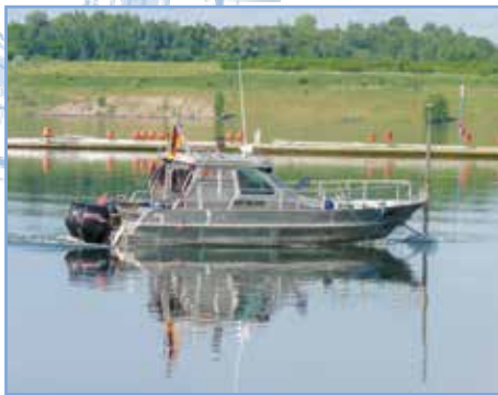
Lotung des Seeboden mit Sonartechnik
