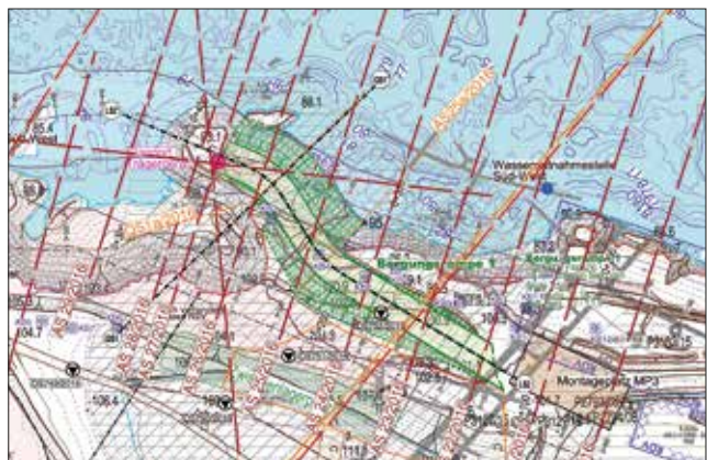
Abb. 12: Schnittführungen für Standsicherheitsberechnungen an der geplanten Sicherungsrampe
