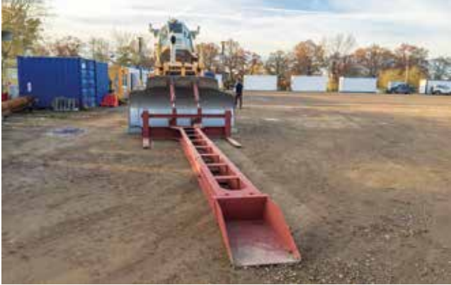
Foto 10: Ferngesteuerte Raupe mit Stechschaufel
