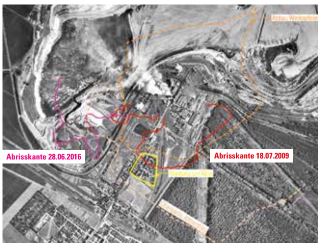
Foto 18: Luftbild Tagebau Nachterstedt 13.06.1969 mit Abrisskanten der Böschungsbewegungen 2009 und 2016
