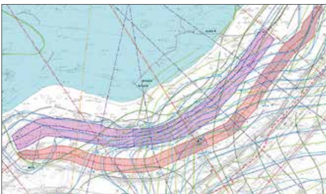
Abb. 22: Rüttelstützkörper +95 m NHN und +103 m NHN im Südabschnitt der Ostböschung mit Hydroisohypsen Hangend- und Hauptmittel-GWL
