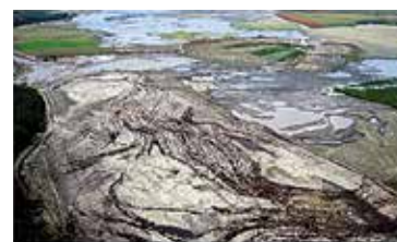
Abb. 8: Seismogramm, Frequenzspektrum und Foto des Grundbruchs Düne Süd Spreetal
