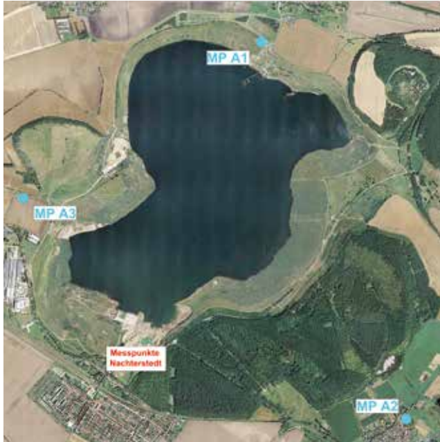
Abb. 2: Seismisches Messnetz nach der Erweiterung durch die Außenstationen A1 bis A3
