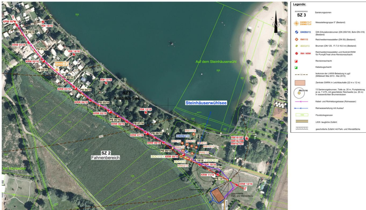
Abb. 6: Lageplan der Pump&Treat-Infrastruktur in SZ3
