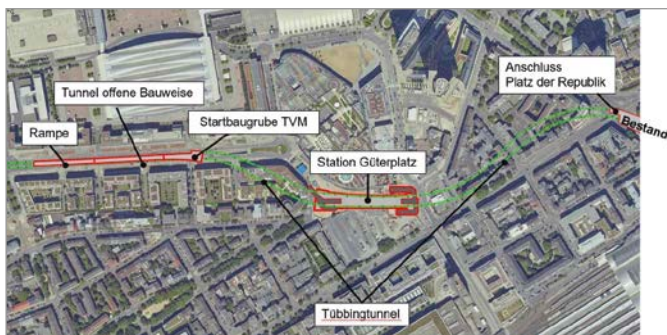
Bild 1 Lage und Bestandteile des Projekts Stadtbahn Europaviertel – unterirdischer Streckenabschnitt Overview of the project Europa District Suburban Railway – underground section
